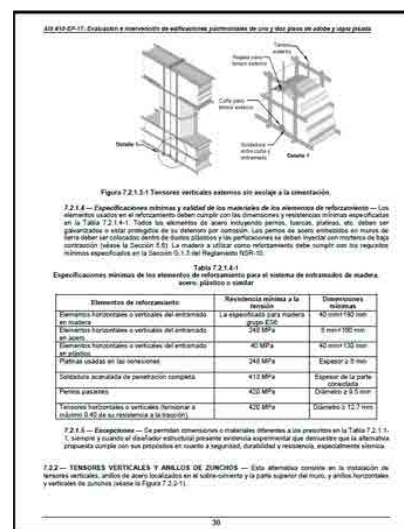
Fig. 5 – Documento AIS 600 – EP – 17: Portada y ejemplo de especificaciones para el reforzamiento de muros con tendones de acero y marcos.
