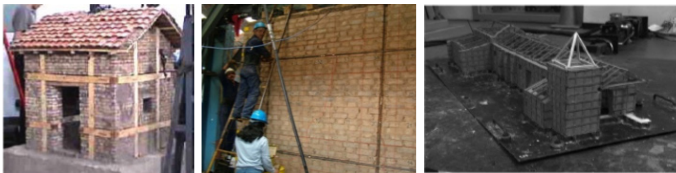
Fig. 3 – Estudios sobre muros y modelos de edificaciones a diferentes escalas reforzados con: a) Marcos de madera [7], b) Tensores de acero [8], c) Marcos de madera en modelo de capilla [9]
