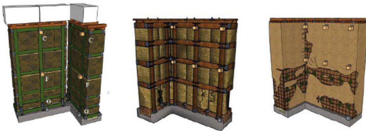
Fig. 4 – Fase experimental del estudio de caracterización del comportamiento de elementos estructurales en adobe y tapia pisada. Fuente [11]
